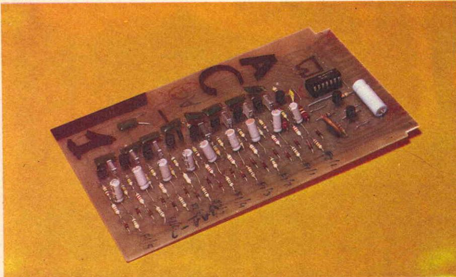
Prototipo del formatore d'onda e divisione.
